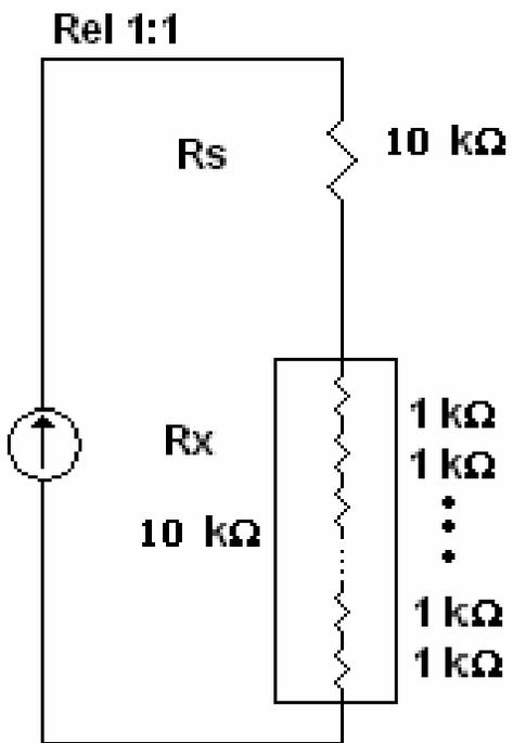
Si se tiene  $R_s = 10\text{k}\Omega$  y se configura  $R_x = 10\text{k}\Omega$ ,  $R_s$  se conoce a 1mA
