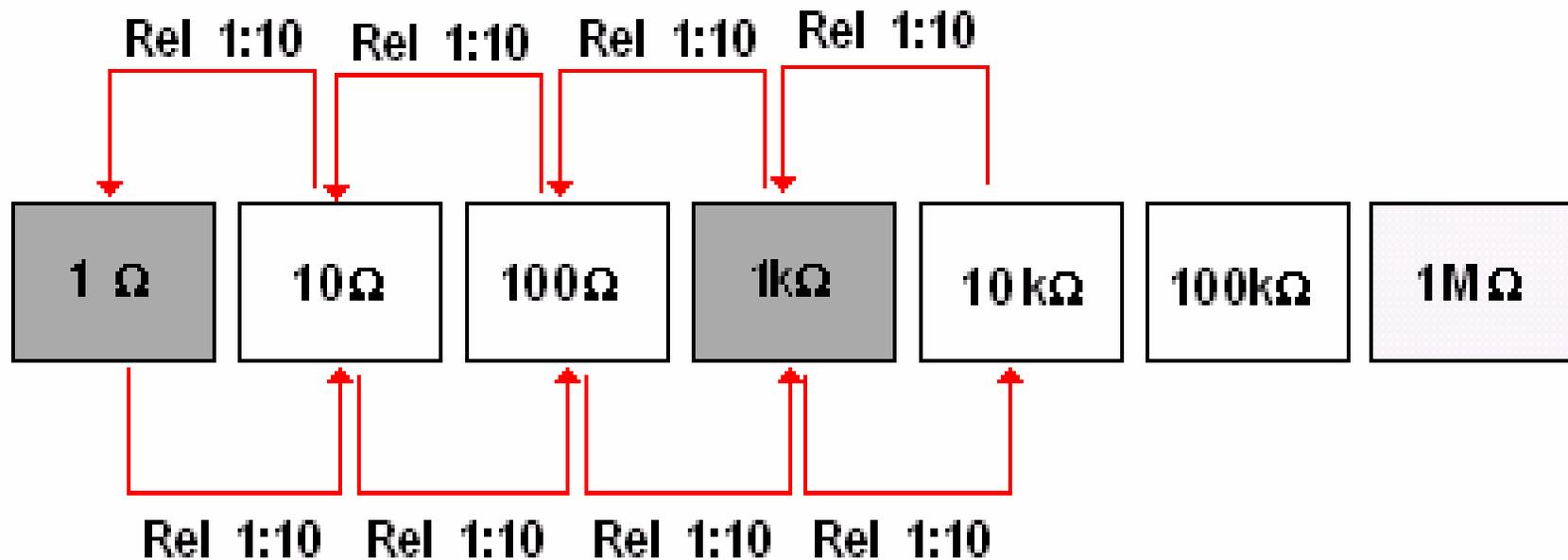
**Realizar calibraciones de resistores en relaciones diferentes a 1:1 impide conservar las condiciones de medición, de tal forma que el efecto se refleja directamente sobre la incertidumbre**
