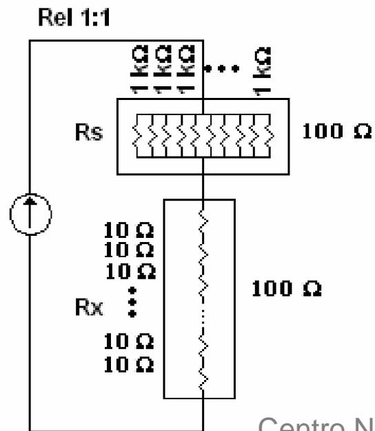
Ahora se puede configurar  $R_s = 100\Omega$  y calibrar  $R_x = 100\Omega$
